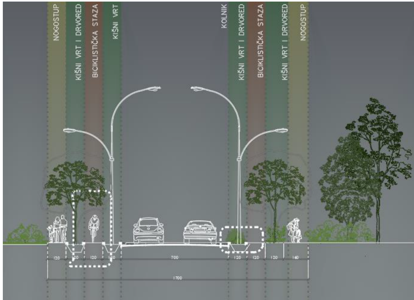
Slika 28. EU projekt proGReg: Prijedlog uređenja ulice u Sesvetama s kišnim vrtovima i drvoredom (Udruga ZIPS)
